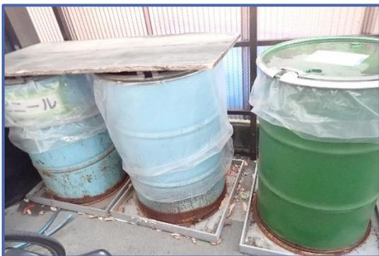
弊社は、ワコンナー(イオン交換塔)を使用しているため、現場で使用する水は全て循環水を使用しており排水ゼロを実現しています。ワコンナーで使用済みになった廃フィルターや、めっき処理の際に使用したビニール等は、化学物質が付着しているため保管の際は、ドラム缶にビニールを入れ保管します。また、ドラム缶の下には升を置き液漏れ対策もしています。ドラム缶に蓋も付いていますが強風対策としてさらに板で蓋をして外部への流出を防いでいます。保管と流出防止を徹底しています。
